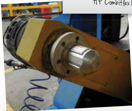
Testata Rotogrip monodiametrale su svolgitore Rotogrip monodiametral chuck on unwinder
